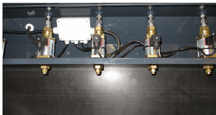
Sprøjtebom udstyret med el-styrede ventiler for hver dyse, for præcis udsprøjtning i ønsket bredde
