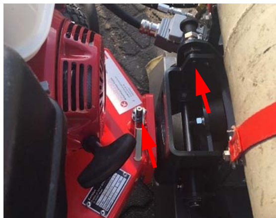
Fig. 3-2: Montering af HOAF WeedAir® til en redskabsbærer
