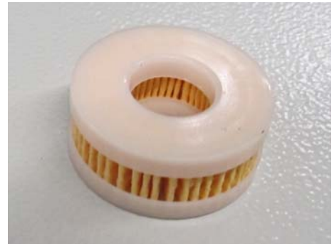
Fig. 9-6: Udskiftning af gasfilter (4)
