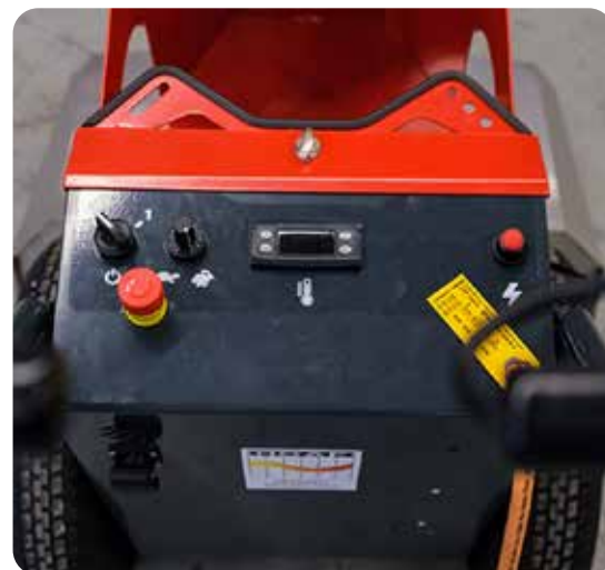
Temperaturmåler, elektrisk tænding og hastighedsregulering
