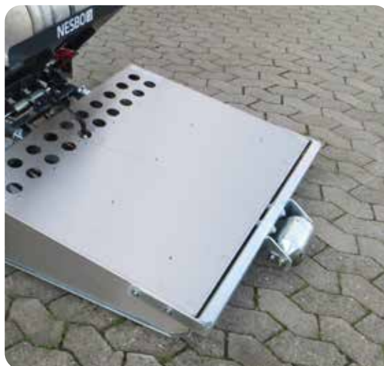
Frontrullen sikrer korrekt højdeafstand
