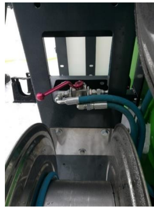
Billede 8.3. Vandet løber til begge slangetromler
