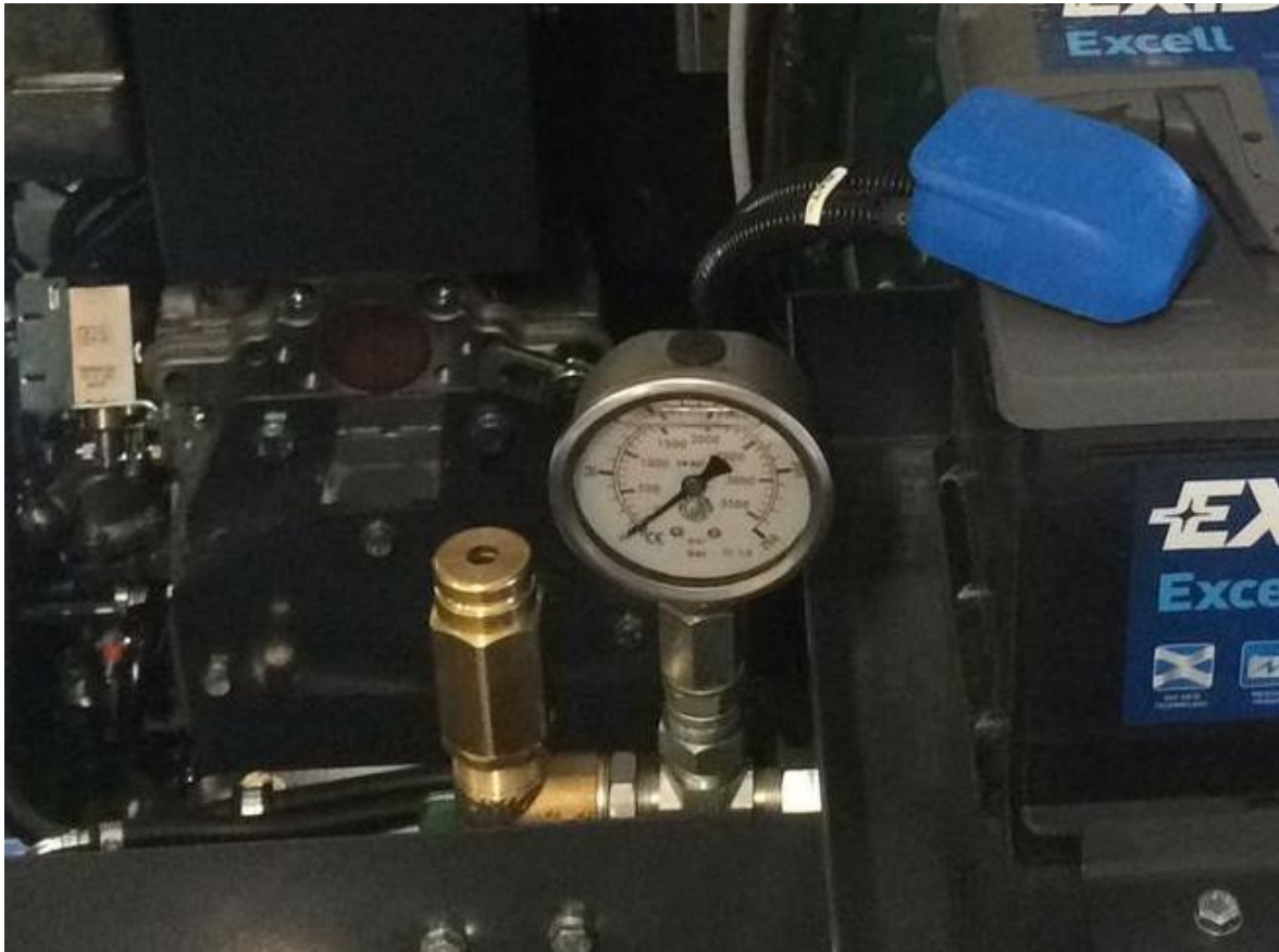
Billede 6. Sikkerhedsventil og trykmåler til ØKO-tilstand
