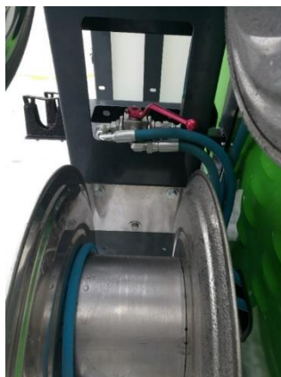
Billede 8.2. Vandet kombineres i én slangetromle (3/8" slange)
